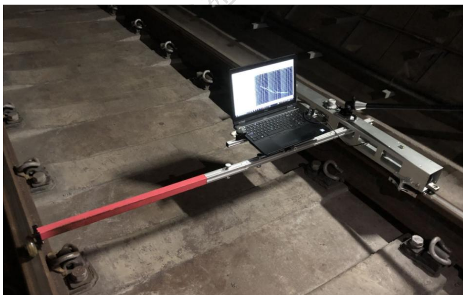
图 7 钢轨几何参数测量
